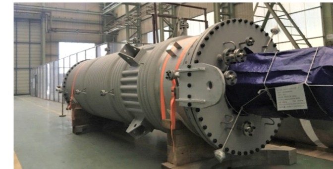
薄膜蒸发器18m 2 Thin Film Evaporator18m 2 适用：甲基丙烯酸甲酯项目 Application industry: MMA Project 材质Material: S31603 外形尺寸（长X宽X高）Size (L x W x H) 1020X195X190cm
